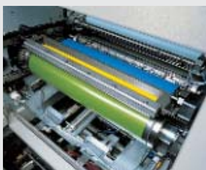
Le camere della racla disinnestabili e asportabili riducono i tempi di lavaggio
