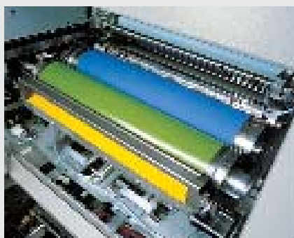
Le camere della racla disinnestabili e asportabili riducono i tempi di lavaggio
